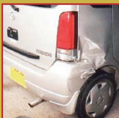
クォーター損傷
